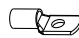
Zacisk tłoczony na zimno typu O (miedz RNB38-8) z acisk okrągły x1
